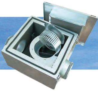
Центробежный вентилятор с назад загнутыми лопатками с круглым подключением и поворотной-откидной дверцей
